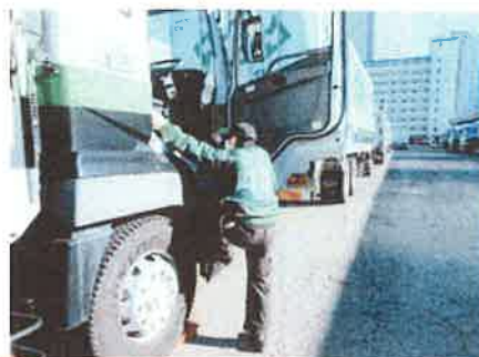
墜落・転落防止：三点支持の徹底
